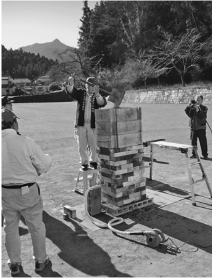
第10図-1 炉に木炭と砂鉄を投入
